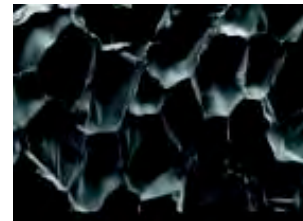
Abb 2: Schaumplatte 230×15 mm 2 und geschlossenzellige Schaumstruktur (Bilder: Fraunhofer ICT)
