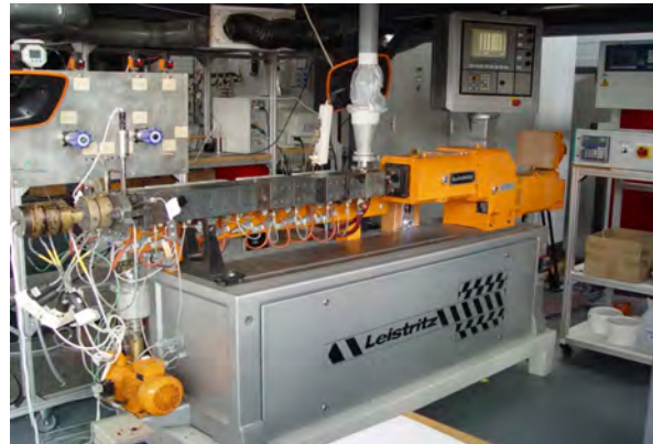
Leistritz Extruder Mikro 27-40D mit Strangdüse Bild: Fraunhofer ICT
